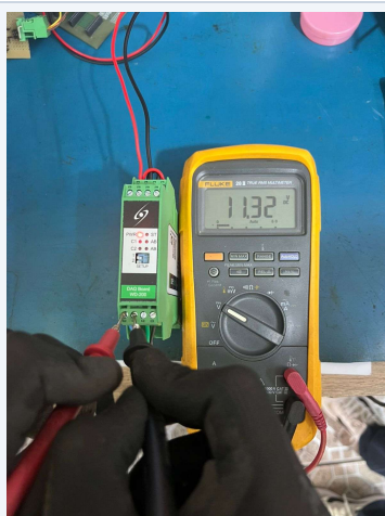
Figura 7 — Medição contínua Pino 1 (VDC) e Pino 2 (GND): 11,32 VDC (OK: 10,5 a 11,7 V).
