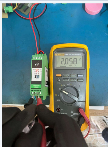
Figura 8 — Medição contínua Pino 2 (GND) e Pino 3 (C1): 2,058 VDC (OK: 1,6 a 2,1 V).
