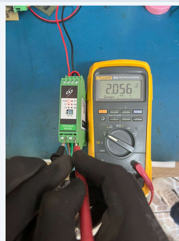
Figura 9 — Medição contínua Pino 2 (GND) e Pino 4 (C2): 2,056 VDC (OK: 1,6 a 2,1 V).
